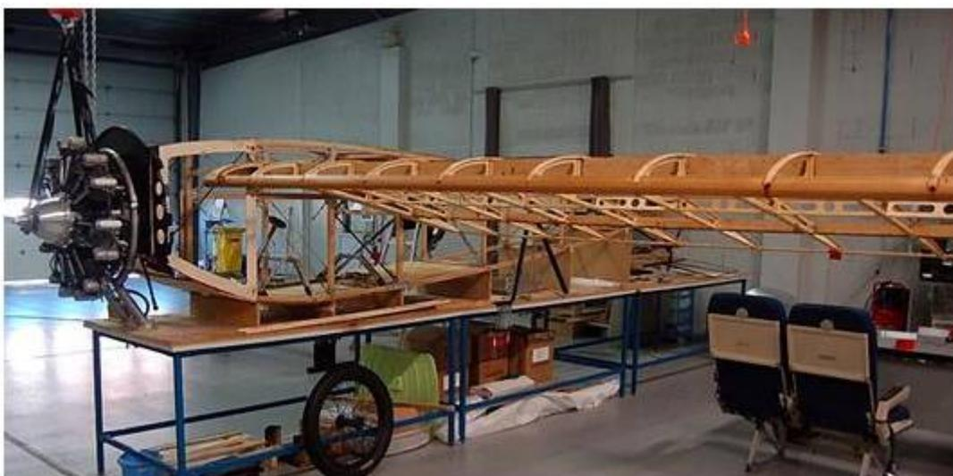
*L'appareil en construction chez « Derichebourg formation » à Montaudran*
