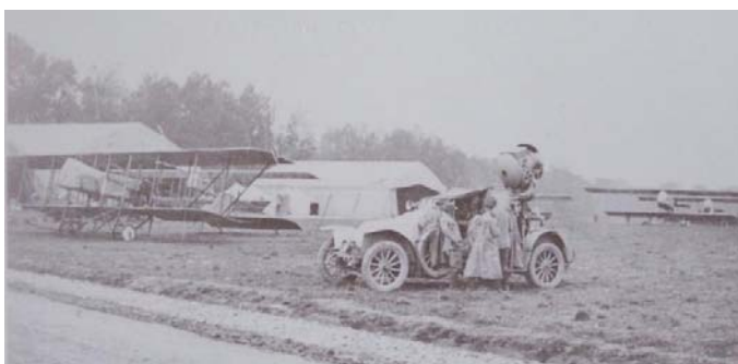
Renault EE 6 cyl. avec un projecteur de 60 cm. Cette Renault est ici en poste pour la signalisation optique des avions (ici des Farman ?) lors des atterrissages.
