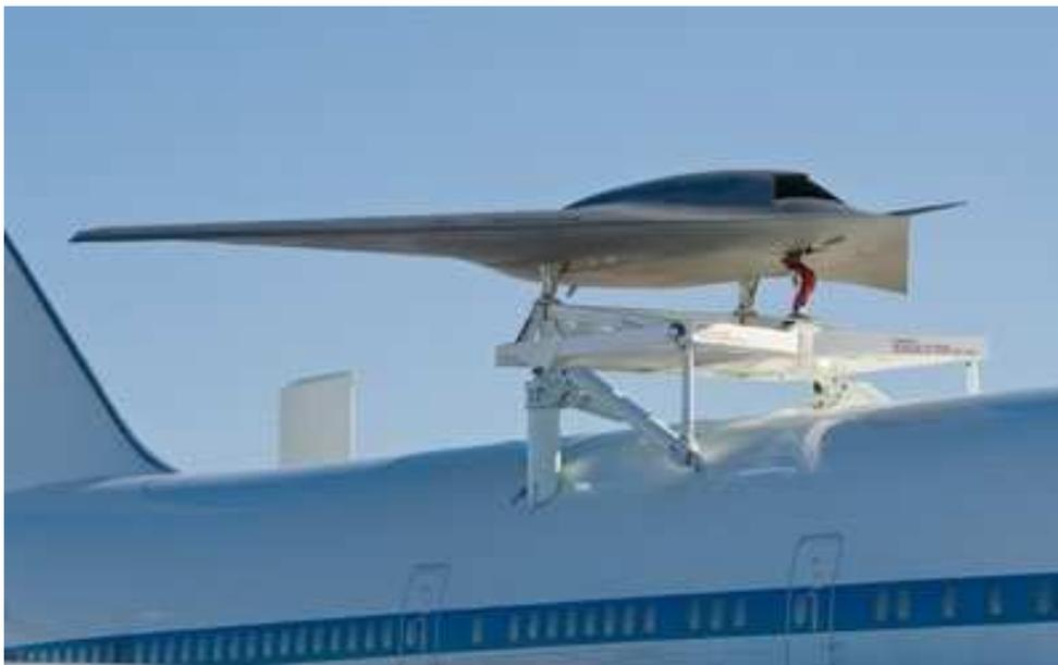
Pour rejoindre le centre d'essais en vol d'Edwards, le drone est monté sur le dos d'un B747 NASA Shuttle Carrier Aircraft (SCA) de la NASA. Le 13 décembre, pour ce premier vol d'essais, le B747 a atteint 14.000 pieds pour vérifier la parfaite intégration du drone sur le porteur de navettes spatiales. Une première en 33 ans d'exploitation du B747 SCA. Ce vol, va être suivi du convoyage du drone à destination de Dryden (Edwards) en Californie.
