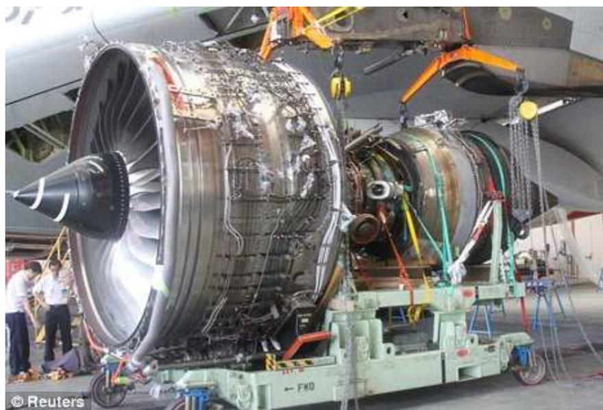
Ce concept (uniquement mis en oeuvre sur les gros moteurs par Rolls Royce) est génial, car il permet d'optimiser chaque turbine (3) au compresseurs (Fan, Compresseur IP et compresseur HP) qu'elles doivent entraîner. Ceci conduit à des moteurs courts, légers et performants, mais d'une technologie complexe.
