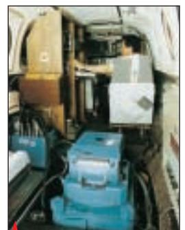
Le navigateur-photographe est assis à la droite du pilote. À sa gauche, en retrait, le logiciel de navigation. La position de l'avion est matérialisée en permanence sur l'écran, ce qui permet d'activer manuellement l'obturateur à la seconde près, lorsque les prises de vues ne sont pas effectuées en déclenchement automatique.
