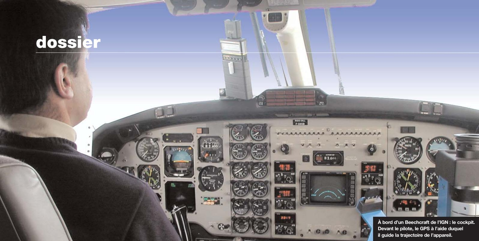
À bord d'un Beechcraft de l'IGN : le cockpit. Devant le pilote, le GPS à l'aide duquel il guide la trajectoire de l'appareil.
