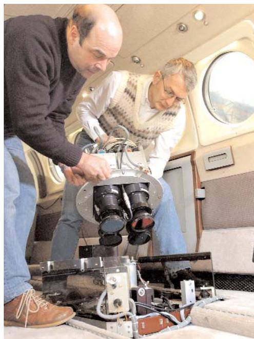
En haut : préparation d'un plan de vol sous GéoMAGIC (Mission aéronautiquement gérée et informatiquement contrôlée). Au centre : dans le hangar de Creil, les mécanos préparent un avion. En bas : mise en place de la caméra numérique quadri-canal.
