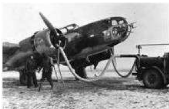
Bloch 131 avec bloc de réchauffage
